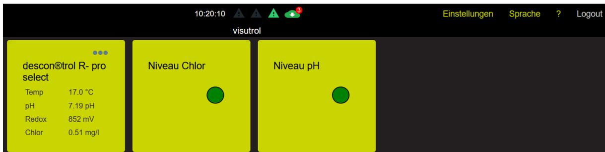
Geräte, die über eine Standard RS485- oder MODBUS-Verbindung angeschlossen sind, zeigen verfügbare Wasserwerte an. In den meisten Fällen: pH, Temperatur, freies Chlor und Redox. Die Ausgabe hängt von der jeweiligen Konfiguration des angeschlossenen Geräts ab.
