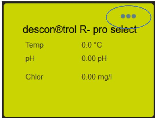
Mit dieser Editierfunktion gelangt man in das Konfigurationsmenü. Klicken Sie auf diese Funktion, um mehr zu erfahren.
